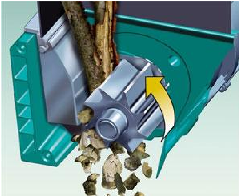
Figure 2: Broyeur à rotor
