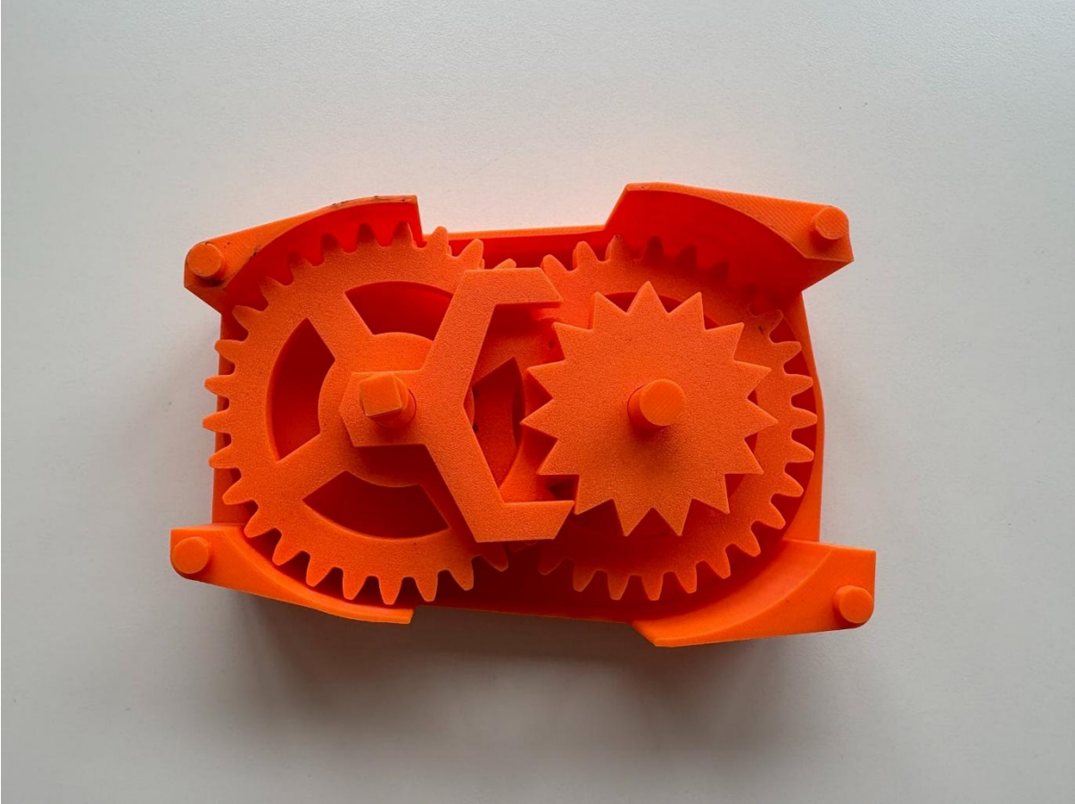
Image du mécanisme de positionnement en impression 3D vu du dessus
